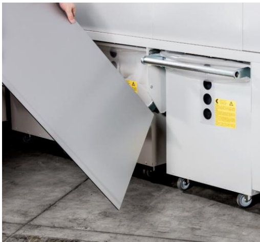
Spänecontainer mit Staubschott
